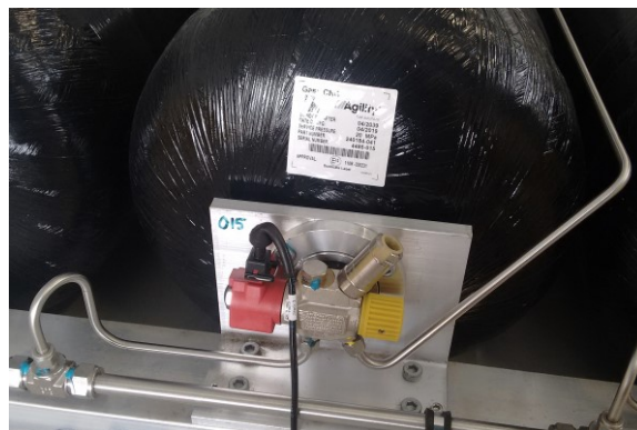
Umístění náhradního štítku - není zalaminovaný, ale perforovaný a pouze nalepený na nádrži.
