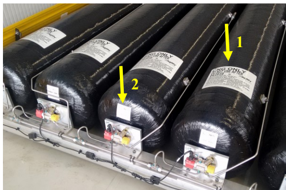
Hlavní (1) a náhradní (2) štítek nádrže. (Zdroj: TUV SÚD Czech s.r.o.)
